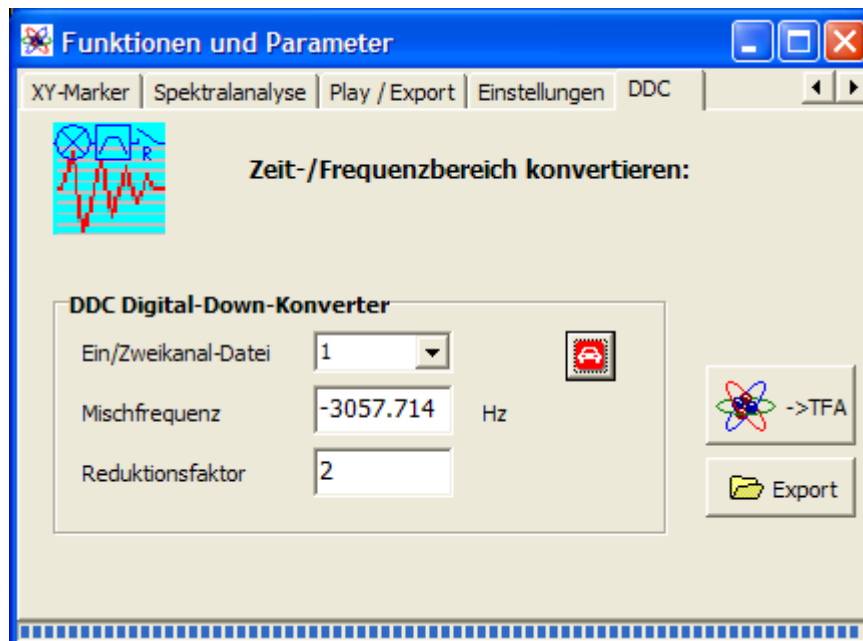
Abbildung 5-28: DDC-Einstellungsvorschlag zur reellen Frequenzumsetzung
